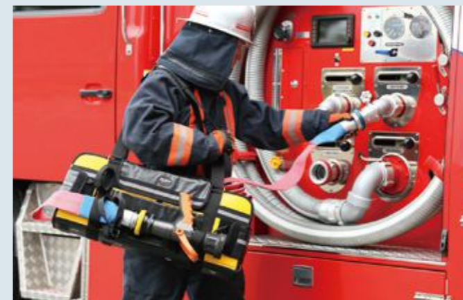
片手操作でジョイントでき、簡単にホースの延長が可能!
