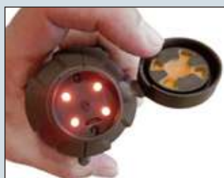
蓄電状態は4つのランプのLEDインジケーターから確認が可能。
